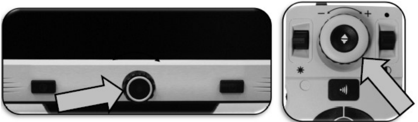
Kuva 10 Etupaneelissa ja ohjauskonsolissa sijaitsevat zoomauspyörät
